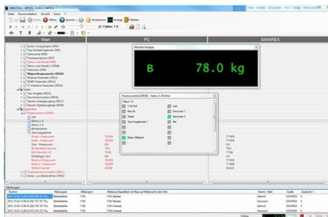
Einstellsoftware SIWATOOL V7, Aufbau der einzelnen Programmfenster
