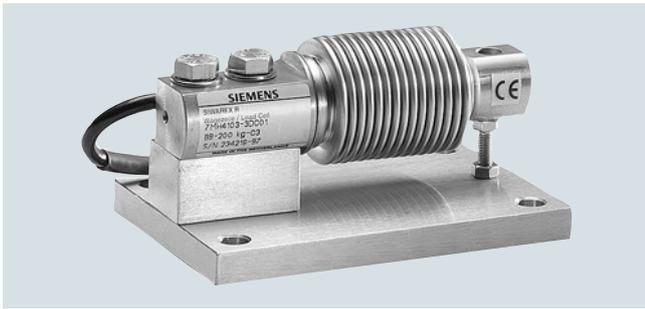
Die Grundplatte mit integriertem Überlastschutz für Wägezellen der Baureihe SIWAREX WL230 BB-S SA ermöglicht die unkomplizierte und funktionsgerechte Montage der Wägezelle.
