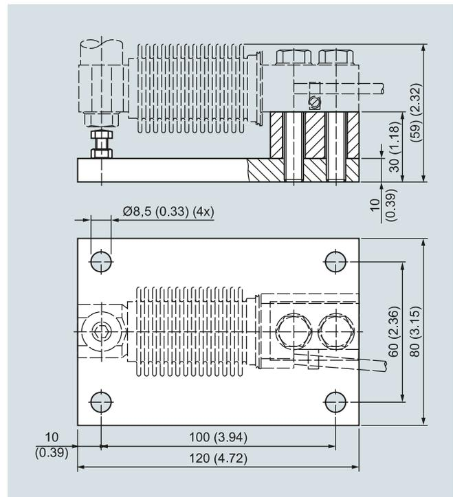
Elastomerlager und Grundplatte mit Überlastschutz für Wägezellen SIWAREX WL230 BB-S SA, 10 ... 200 kg (22.05 ... 440.92 lb), Maße in mm (inch)
