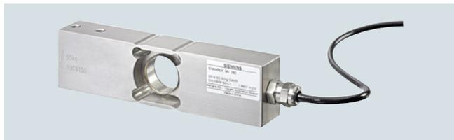
Die Wägezelle SIWAREX WL260 SP-S SC eignet sich ausgezeichnet für den Einsatz in eichpflichtigen Plattformwaagen. Sie ist zugelassen für den Einsatz in Handelswaagen der Klasse III mit maximalen Teilzahlen  $n_{\max}$  bis 4 000d. Für hochgenaue Anwendungen steht eine Variante C4 MR zur Verfügung, mit einem  $Y = 40\,000$ .
